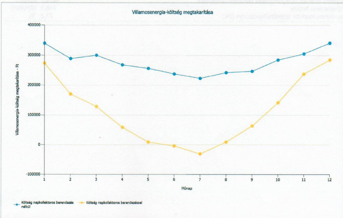
Ábra: Villamosenergia-költség megtakarítása
